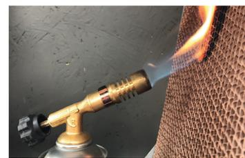
Bild 3 Beflammung einer Tafel im Brennkasten
