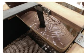
Bild 4 Beschichtung durch Suspensions-Vorhang
