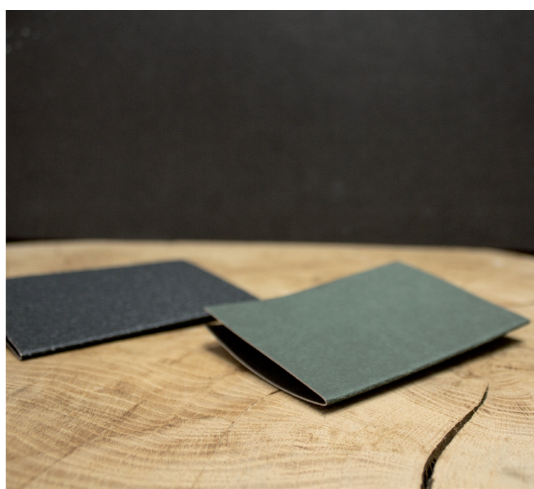
Bild 1 Aluminium und Vulkanfiber ("2 mal nass" Technik) gekantet im Vergleich
