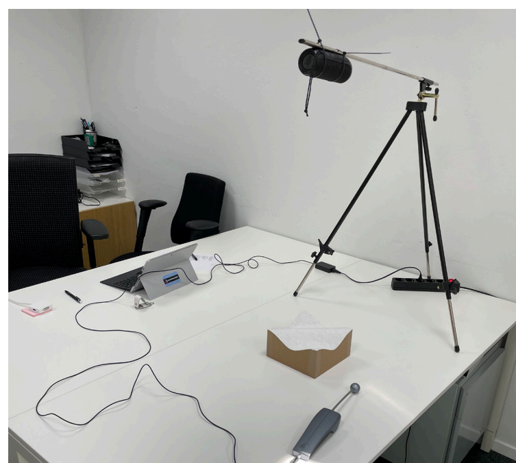
Bild 2 Versuchsaufbau Experiment 1 Messungen mit SonoCat
