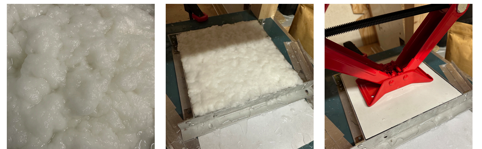
Bild 3 Materialpulpe und Pressvorgang in der Vorrichtung aus Experiment 2
