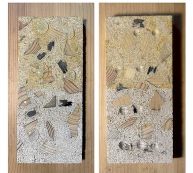
Bild 5/6 Prüfpatten Wasserbeständigkeit/Härtetest
