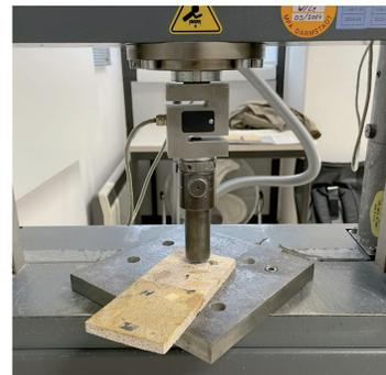
Bild 4 Härteprüfung nach DIN EN 13892-6:2002
