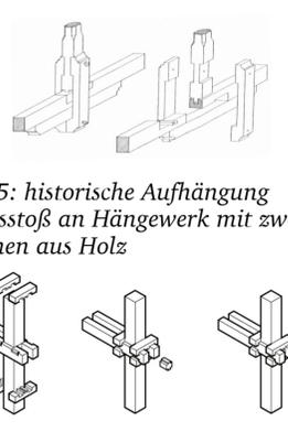
Bild 5: historische Aufhängung Längsstoß an Hängewerk mit zwei Laschen aus Holz
