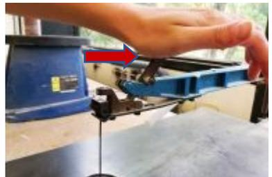
(Vorsicht: Gleitet der Einspannblock oben nicht gerade so in die Halterung, ist das Sägeblatt zu locker oder zu fest gespannt und kann reißen bzw. verursacht schlechte Schneideergebnisse)
